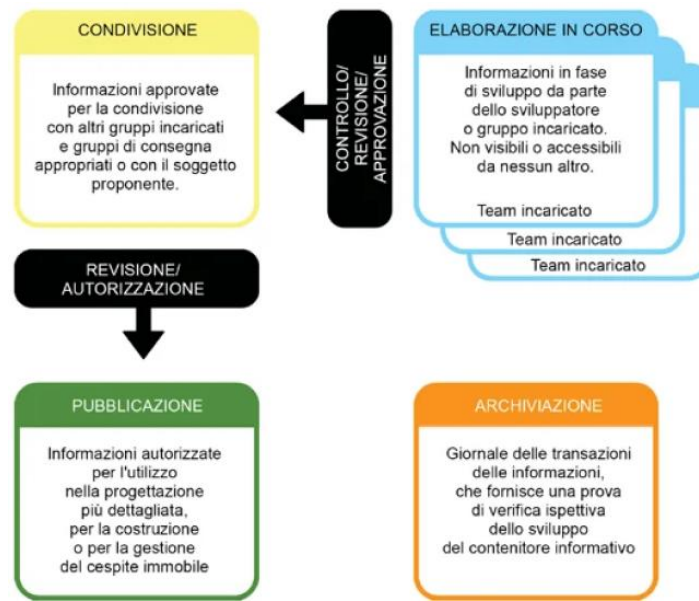
Immagine 1 - Struttura percorsi ACDat-Aff
